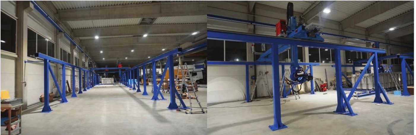
Portalkonstruktion (26 m Verfahrweg in der X-Achse, 7 m Breite)
