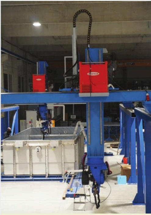
Roboter und Schweißstromquelle
