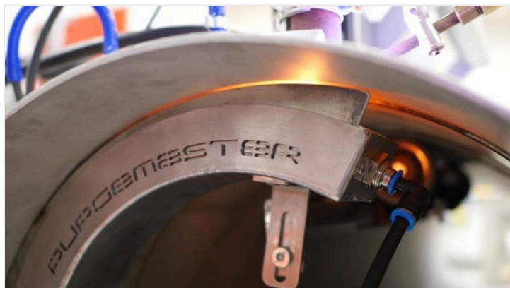
Komora PurgeMaster v cevi
